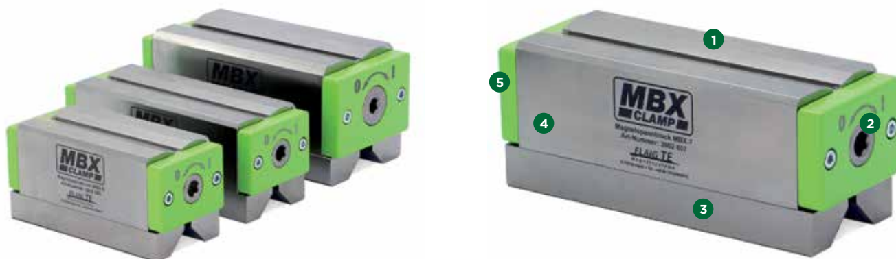
Figura. (1) Lado de sujeción para material plano y redondo. (2) Puede ser activado por ambas caras. (3) Lado de sujeción con superficie a 90° para diversas formas de piezas. (4) Superficie totalmente niquelada. (5) Puede ser activado por ambas caras.
