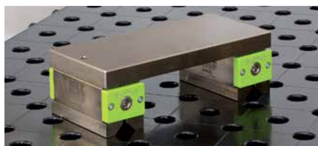
Figura. (1) Lado de sujeción para material plano y redondo. (2) Puede ser activado por ambas caras. (3) Lado de sujeción con superficie a 90° para diversas formas de piezas. (4) Superficie totalmente niquelada. (5) Puede ser activado por ambas caras.
